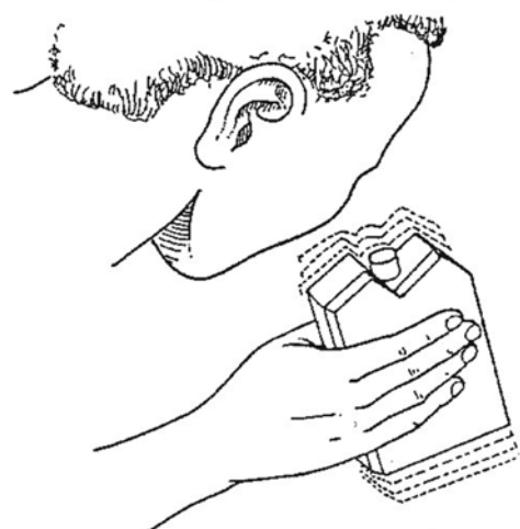
Figure 2.23 Vérification du conditionnement correct d'un accumulateur d'eau congelée
